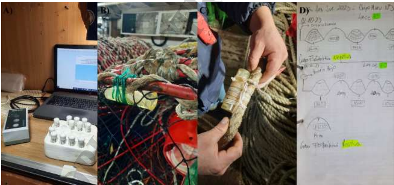
Figura 5. A) Sensores de profundidad autocontenidos (“dataloggers”) y (B) su ubicación en la trampa, (C) en la línea madre, y (D) un ejemplo del diagrama operativo, en la Campaña de evaluación del recurso centolla ( Lithodes santolla ) en el Área Sur de Manejo, a bordo de buques comerciales, primavera 2023.
