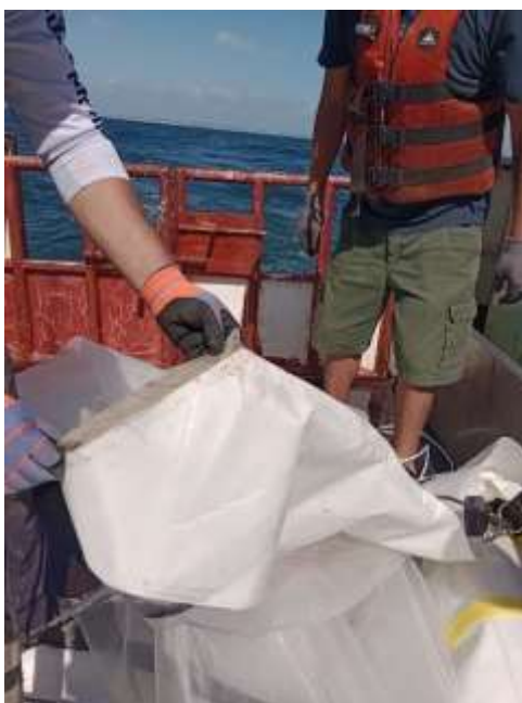
Figura 5. Detalle del desperfecto observado en la red Tucker ocurrido durante la campaña de verano de 2024.
