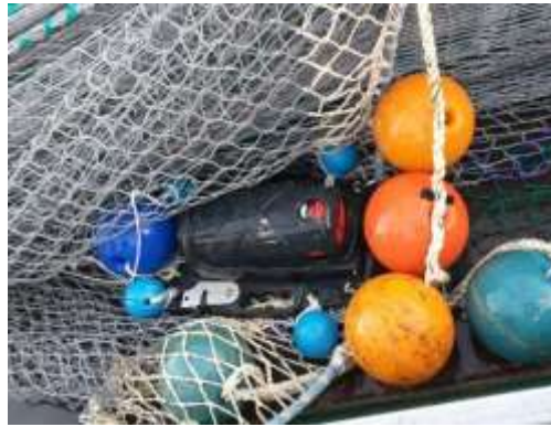
Figura 6. Ojo de red colocado en relinga superior, compensado con flotación.
