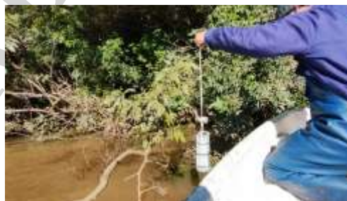
Figura 2. Instalación del hidrófono autocontenido en la costa de la margen argentina.
