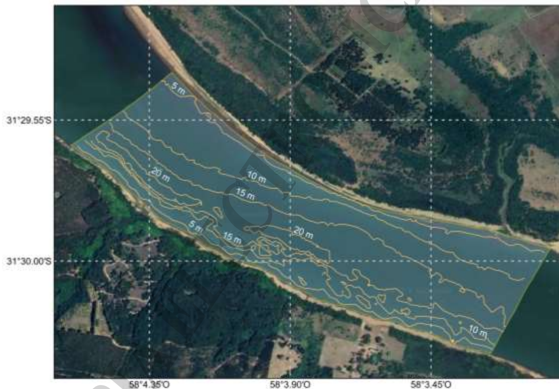
Figura 12. Mapa batimétrico del área donde se realizaron los relevamientos acústicos intensivos, las profundidades en metros se indican mediante isolíneas.
