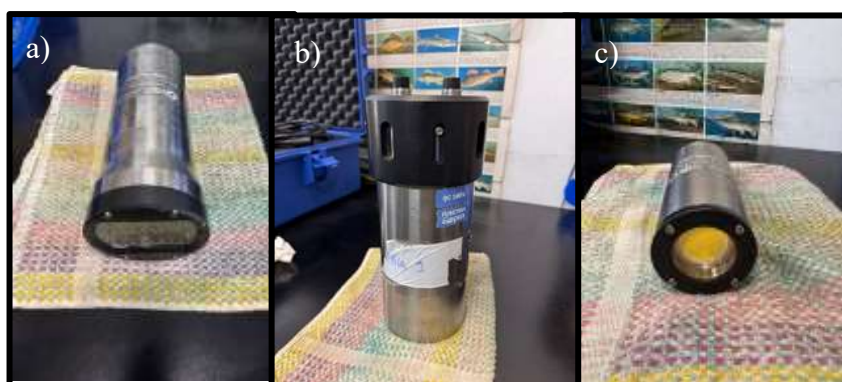
Figura 24. Cámara submarina (a), batería (b) y luces LED (c).
