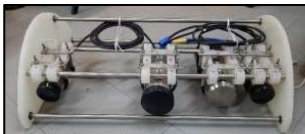
Figura 26. Estructura utilizada para el montaje de la cámara submarina y sus componentes durante la campaña VA-2026/02.
