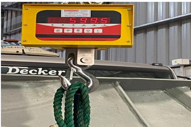
Figura 6. Pesada de portón “ALFA”.
