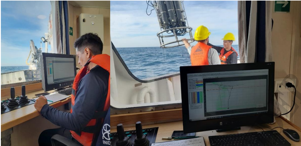
Figura 4b. Operación de la mini roseta-CTD, con las botellas Niskin utilizada para el muestreo de agua.
