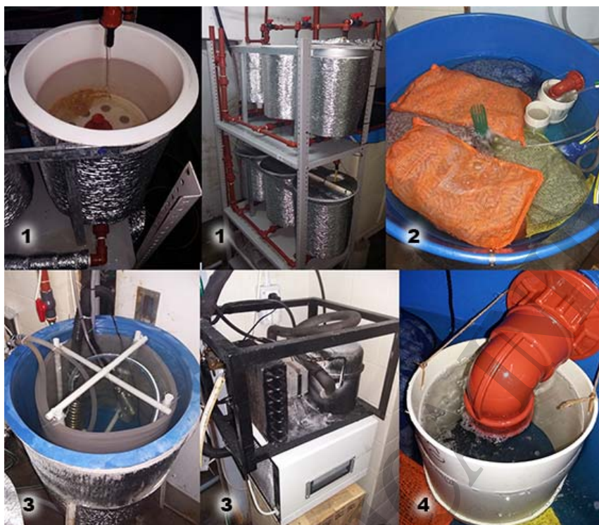
Figura 3. Detalle de algunos elementos del circuito de recirculación empleado para el desarrollo larval y mantenimiento de ejemplares de centolla ( Lithodes santolla ) en el INIDEP. 1) Larvarios con juveniles, 2) filtro biológico, 3) enfriador (parte interna y los dos equipos frigoríficos utilizados) y 4) colector de larvas.
