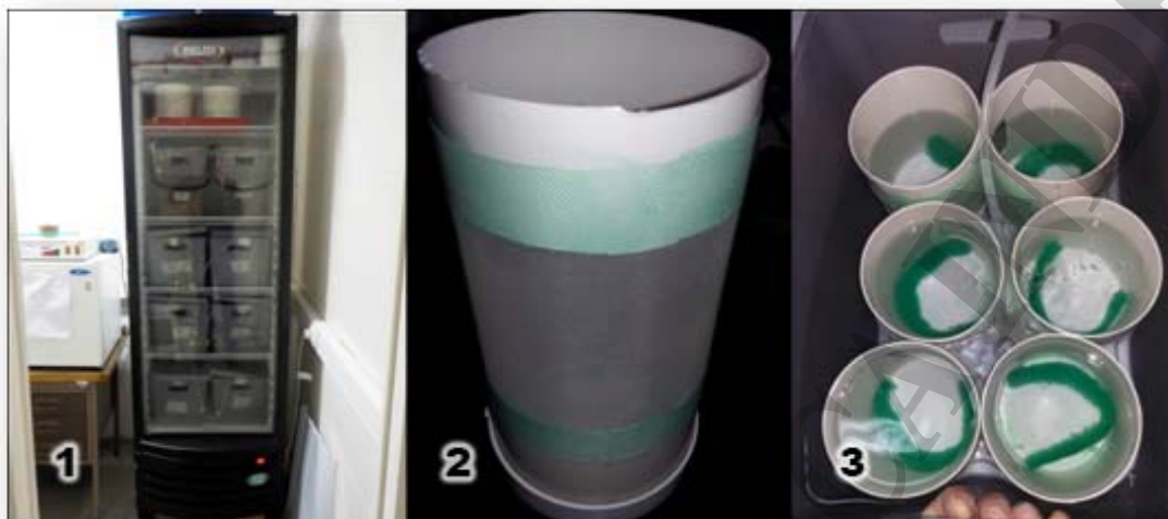
Figura 5. Detalle de los implementos utilizados para el desarrollo larval de ejemplares de centolla ( Lithodes santolla ) en el INIDEP. 1) Heladera exhibidora 2) recipientes cilíndricos de PVC y 3) tubos de PVC dentro del contenedor con una esponja de sujeción para las larvas.
