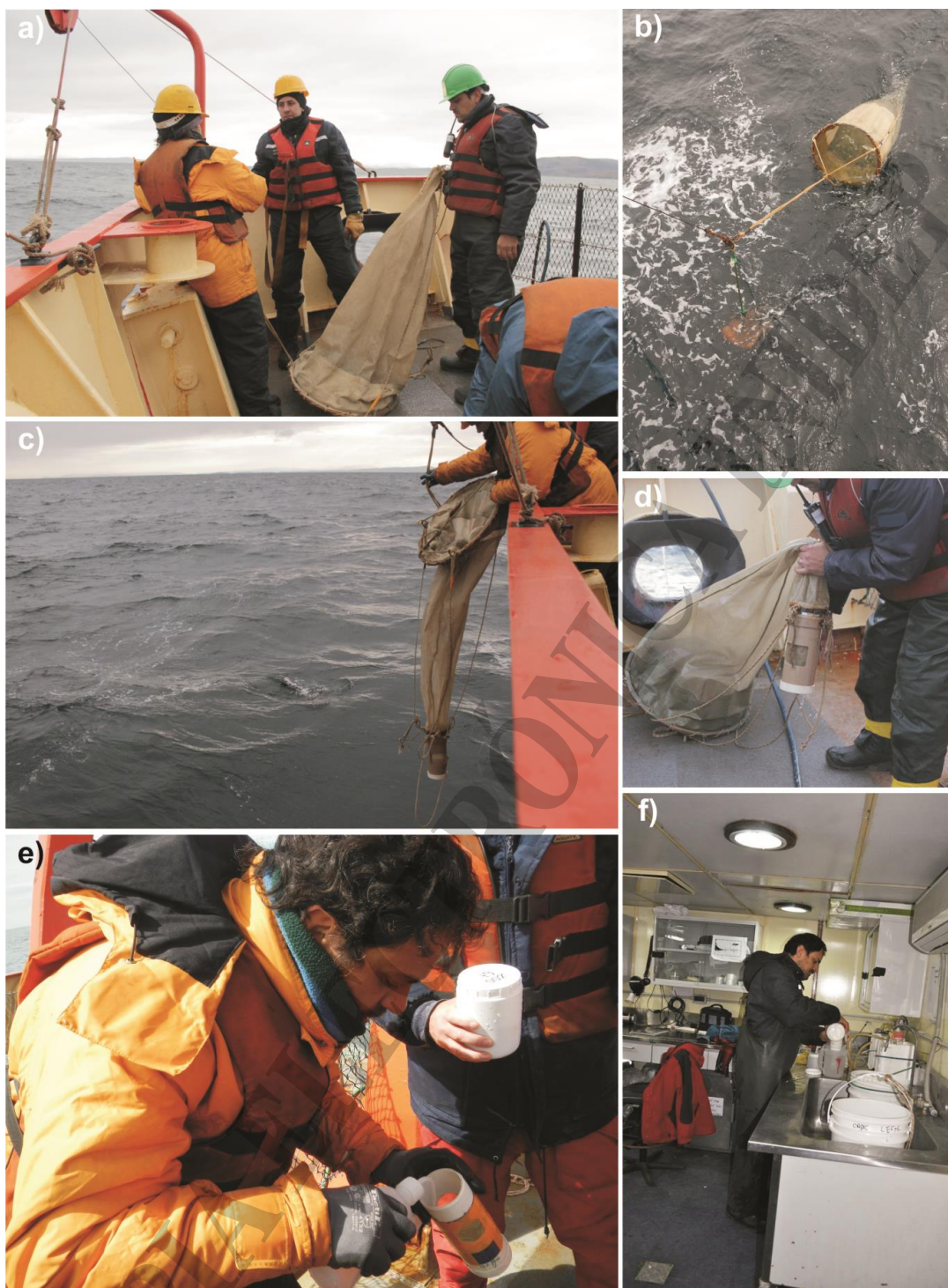
Fig. 1. Detalle de las maniobras realizadas con red cónica de 0,6 m de diámetro, 2 m de largo y mallero de 200 \mu\text{m} . a) Pasteca ubicada en popa sobre banda de estribor, utilizada con el guinche oceanográfico para el arrastre de la red, b) red en el agua, c) alzado de la red, d) y e) enjuague del colector para trasvasar el contenido a un frasco plástico, f) filtrado de la muestra para retirar el agua excedente y posterior almacenamiento de la muestra en frascos rotulados.
