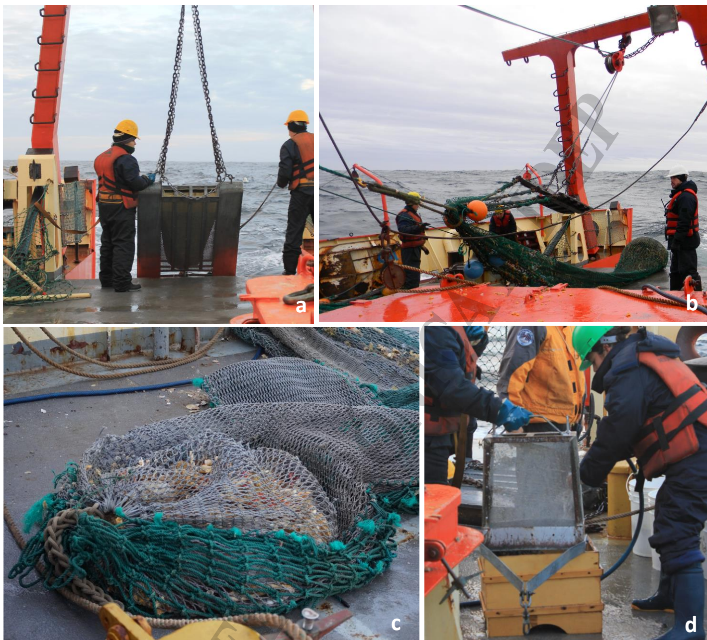
Figura 1. Distintos artes de pesca utilizados para el muestreo. a. Rastra Epibentónica Grande. b. Red Piloto. c. Red de Portones. d. Rastra Epibentónica para Micromoluscos. Fotos: Mónica Torres (CADIC).
