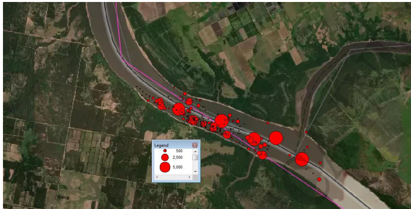
Figura 4. Valores de densidad acústica asignados como surubí. Los círculos rojos son proporcionales a los valores de coeficiente de retrodispersión por unidad de área.
