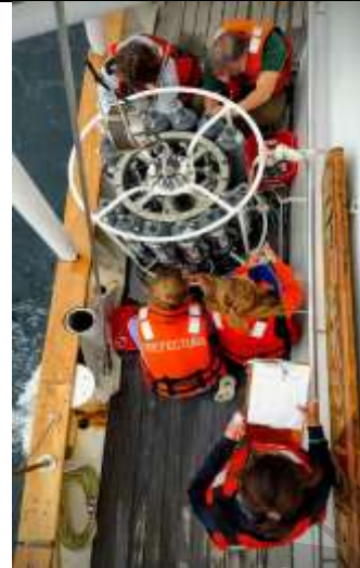
Figura 5. Recolección de agua de mar de: a) superficie con balde y b) distintas profundidades con botellas Niskin
