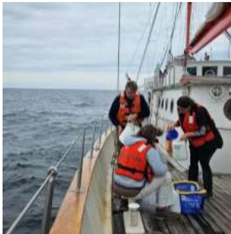
Figura 5. Recolección de agua de mar de: a) superficie con balde y b) distintas profundidades con botellas Niskin
